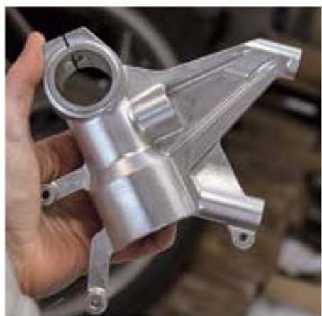
Hubert Hofmann hat mit Fahrwerken von Rennmaschinen angefangen. Heute baut seine Firma die meisten Fahrwerksteile aus Alu. Links ein Prototypen-Gabelfuß, unten ein Gabelstopfen.
