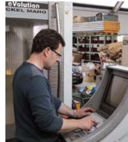
Die meisten Alu-Teile entstehen heute aus einem CAD-Modell in der exakten CNC-Fräse (Spanantrieb unten).
