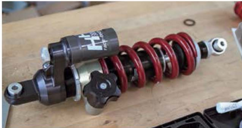
Fertigungstiefe: Am Race-Tech-Federbein sind nur die Stahlteile zugeliefert.
