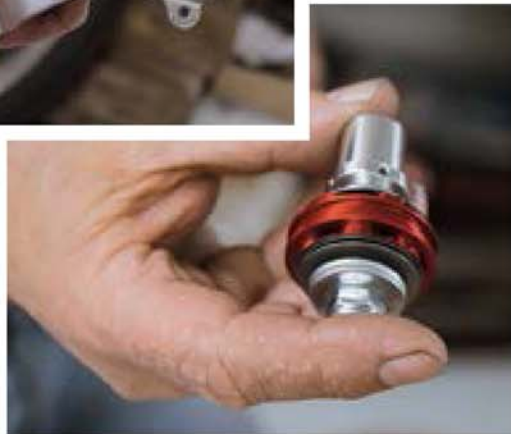
Hubert Hofmann hat mit Fahrwerken von Rennmaschinen angefangen. Heute baut seine Firma die meisten Fahrwerksteile aus Alu. Links ein Prototypen-Gabelfuß, unten ein Gabelstopfen.
