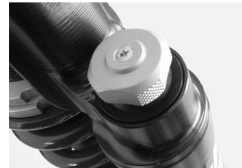
Bild 4 Druckstufenversteller am Stoßdämpferkopf
