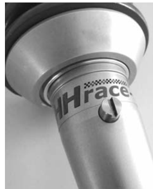
Bild 3 Zugstufenverstellung über Verstellerschraube
