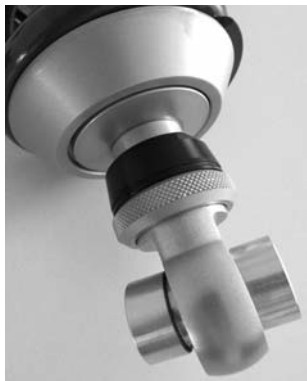
Bild 2 Zugstufenverstellung via Klicks
