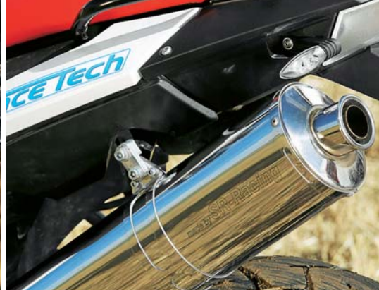
Glanzparade: Der Schalldämpfer von SR-Racing bringt etwas mehr Leistung (siehe unten) – aber nicht mehr Lärm
