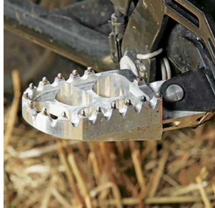
Standfest: Die Alu-Fußrasten sehen gut aus und bieten den Stiefelsohlen unter allen Bedingungen verlässlichen Grip
