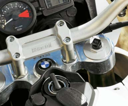
Regelwerk: Federbasis, Zug- und Druckstufendämpfung sind einstellbar, die Gabelbrücken aus dem Vollen gefräst
